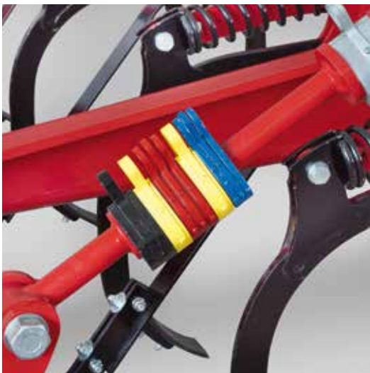
Регулировка глубины работы с помощью AluClips
