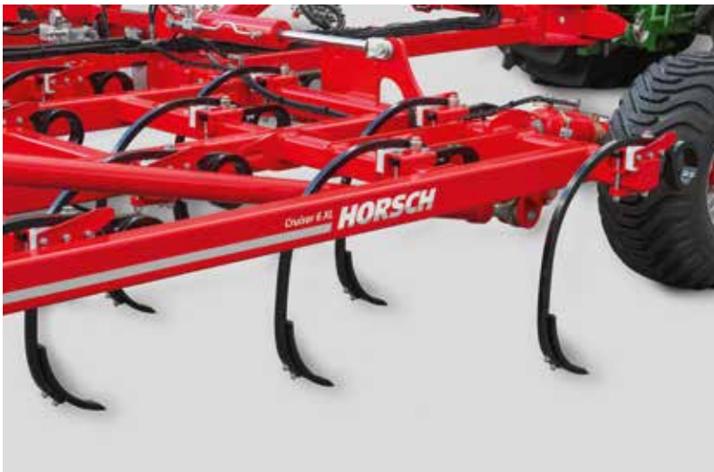
Пружинные стойки HORSCH (усилие срабатывания 150 кг)
