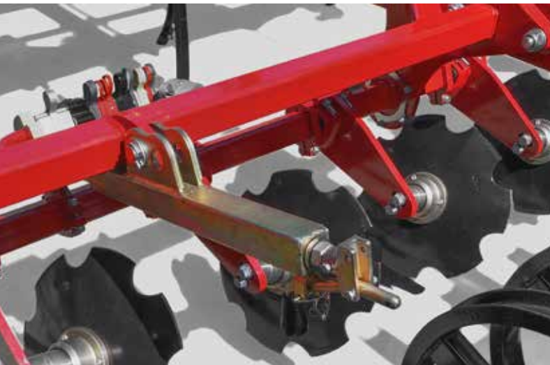
Регулировка глубины хода выравнивающих дисков
