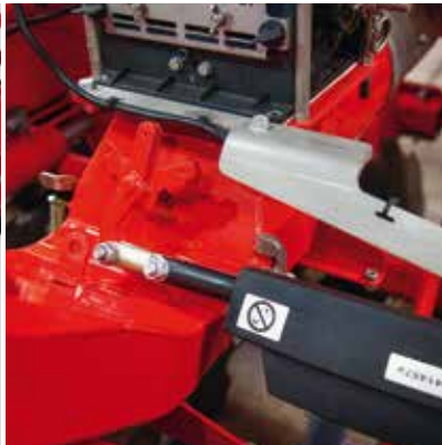
Электрическое отключение половины рабочей ширины Pronto 6 DC/AS
