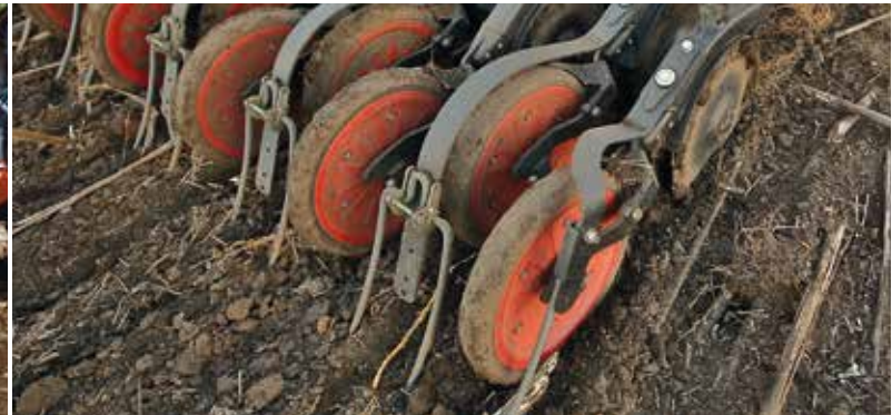
Двухдисковый сошник Гладкие диски с расположенными внутри необслуживаемыми подшипниками
