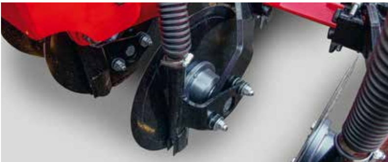
Туковые сошники HORSCH PPF-System для адресного внесения удобрений в междурядья создают оптимальные условия для развития всходов.
