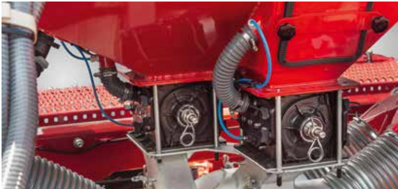
Два одинаковых дозатора Точное дозирование посевного материала и удобрений
