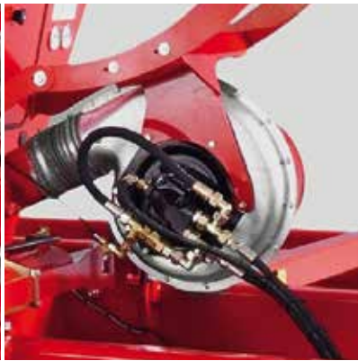
Вентилятор пневмосистемы с гидравлическим приводом
