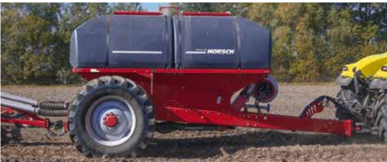
Прицепной бункер HORSCH объемом 12 000 л для семян и удобрений (50:50)
