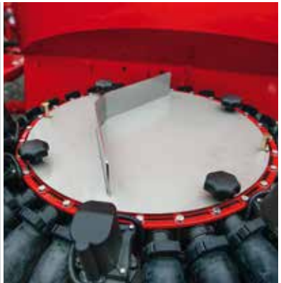
Отключение высева одной из сторон Pronto 8/9 DC
