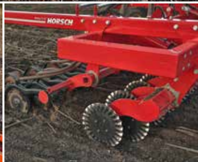
Разрезающие диски рифлёной формы эффективно обрабатывают почву и оказывают малое тяговое сопротивление.
