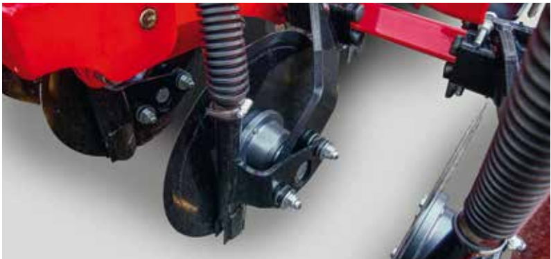
Туковые сошники PPF Необслуживаемые подшипники, высокое давление на сошник
