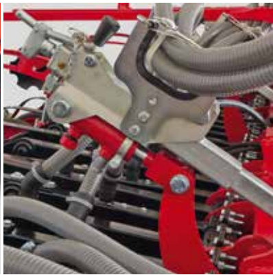
Опциональная гидравлическая регулировка давления на сошники
