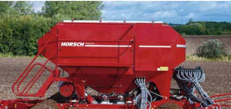
2-секционный бункер большого объёма Объём до 5 000 л, семена/удобрения (40:60)
