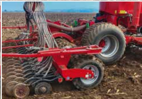
Шасси Pronto AS Большие колёса (800/40–26,5), с низким сопротивлением, не повреждающие почву при работе в поле Рама с трёхточечной навеской Быстрая, простая замена навесного оборудования
