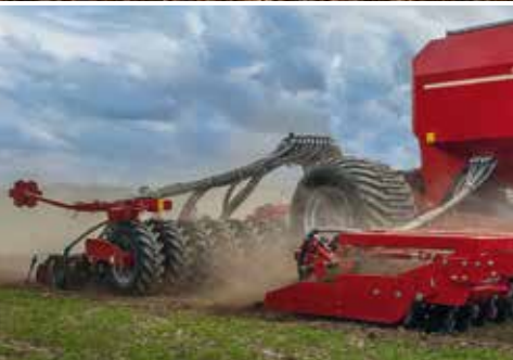
Шасси Pronto AS Большие колёса (800/40–26,5), с низким сопротивлением, не повреждающие почву при работе в поле Рама с трёхточечной навеской Быстрая, простая замена навесного оборудования
