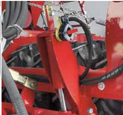
Простая настройка глубины заделки при помощи алюминиевых упоров
