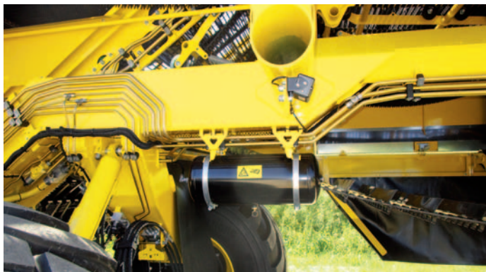
Дополнительные камеры для просеивающего транспортера, транспортера ботвы, игольчатого транспортера, сортировочного стола и камера заднего вида
