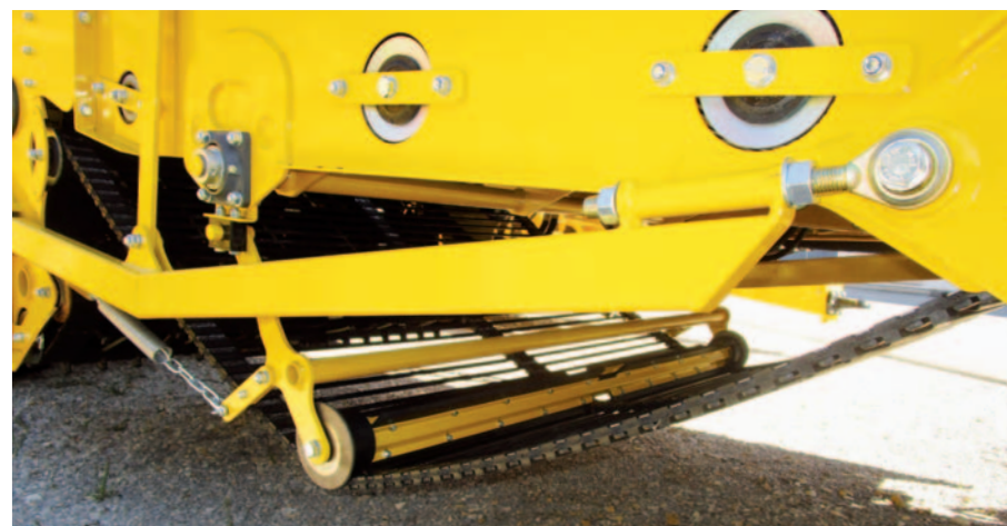
Натяжное устройство просеивающих транспортеров с интегрированным чистящим валиком
