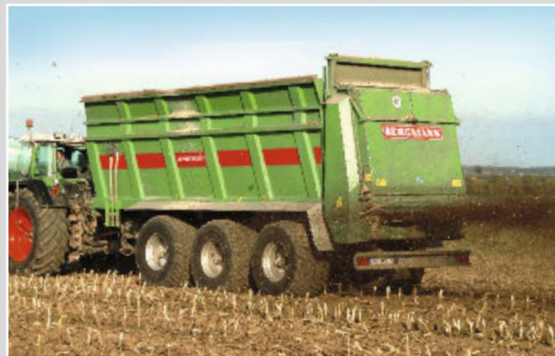
TSW A 21 сменный разбрасыватель с доп. бортами (до 34 м<sup>3</sup>)
