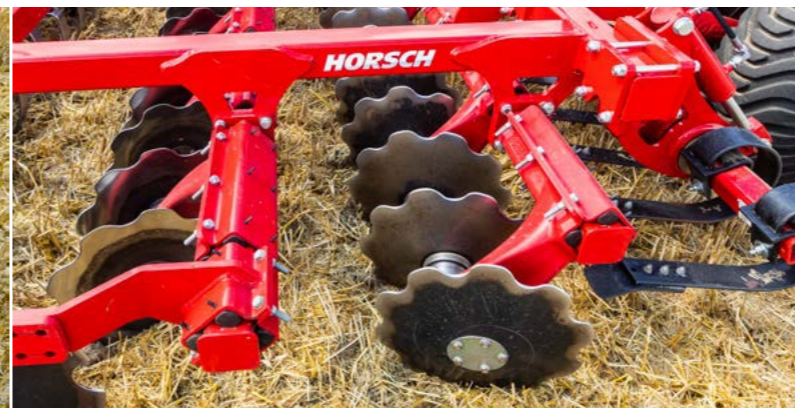
Монтаж двух дисков на одной стойке увеличивает свободное пространство в рабочей зоне машины
