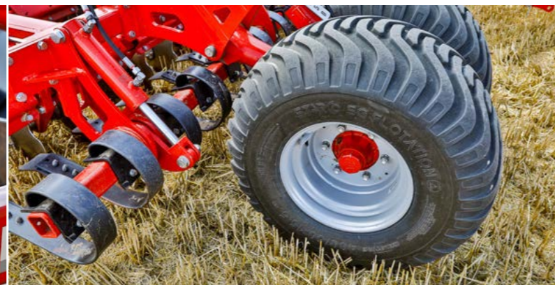
Глубина обработки регулируется изменением положения опорных колес
