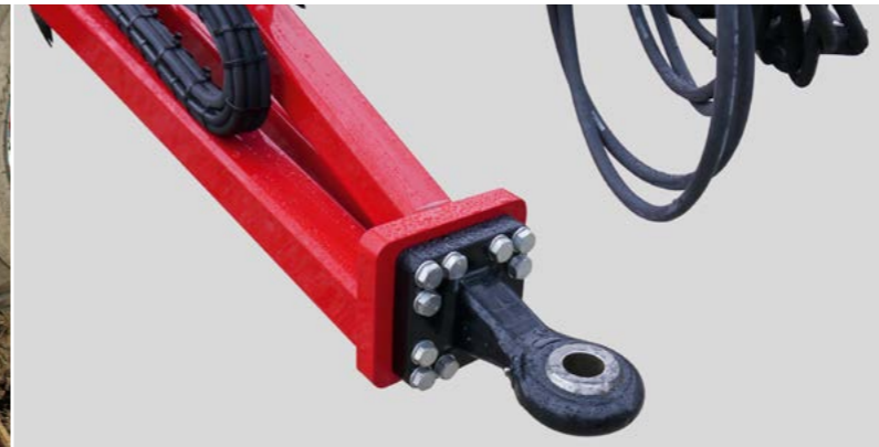
Прицепное устройство с серьгой (с шарниром)
