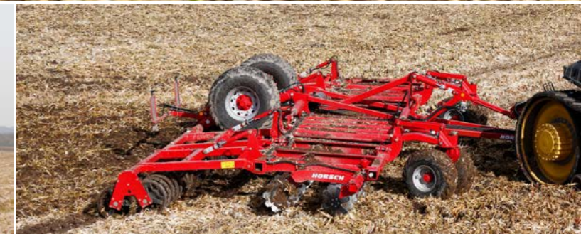
Опция Для Joker 5/6/8 RT: гидравлическая регулировка глубины хода
